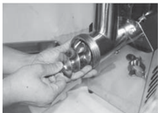
Rys. 4 Ostrożnie zdjąć ostrze tnące, uważając na ostre krawędzie.
