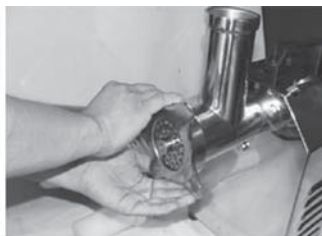
Rys. 2 Odkręcić nakrętkę blokującą.
