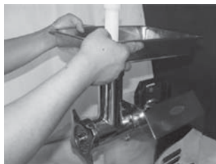
Rys. 1 Zdjąć tackę na mięso, jednocześnie przekracając i pociągając ją do góry.
